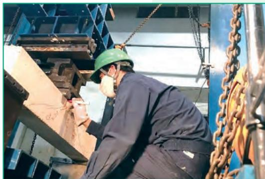
鉄筋コンクリートの力学性能を調べるための50t載荷試験装置
