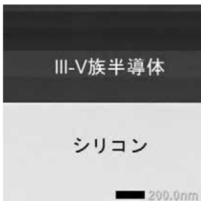
図2 ハイブリッド基板接合界面の電子顕微鏡写真 [4] 光集積回路内素子の特性例
